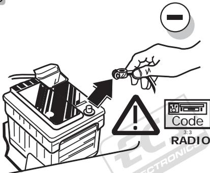
**DE** Um Störungen und Schäden am Bordnetz zu vermeiden, muss die Massepolklemme unbedingt vor Beginn aller Arbeiten von der Fahrzeugbatterie getrennt werden! Insbesondere bei Arbeiten und Anschlüssen am CAN-Datenbus kann bei nicht abgeklemmter Batterie sowohl das Anhängermodul als auch das fahrerseitige Bordnetzsteuergerät beschädigt werden! Bitte Herstellervorschriften beim Ab- und Anklemmen der Fahrzeugbatterie beachten!
